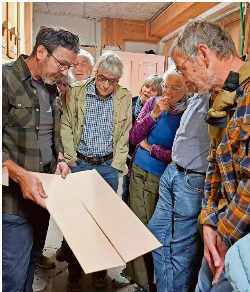
Andrea Florinett zeigt den Gästen in Latsch eine frisch geschnittene Resonanzdecke für eine akustische Gitarre während des Lufttrocknungsprozesses.
